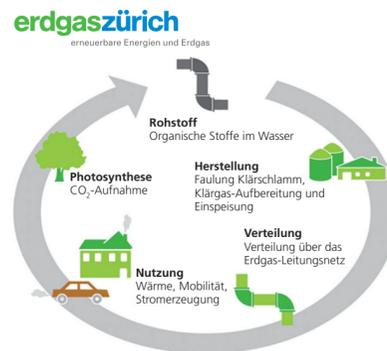
Die beiden Hauptkomponenten des Klärgases sind Methan (60%) und CO<sub>2</sub> (40%). Damit das anfallende Klärgas ins Erdgas-Netz eingespeist werden darf, muss es zuerst in der Biogasaufbereitungsanlage vom CO<sub>2</sub>-Anteil und anderen Spurenstoffen befreit und getrocknet werden. Diese Verfahrensschritte wurden bei der ARA Rorguet mit einer chemischen Wäsche umgesetzt.
