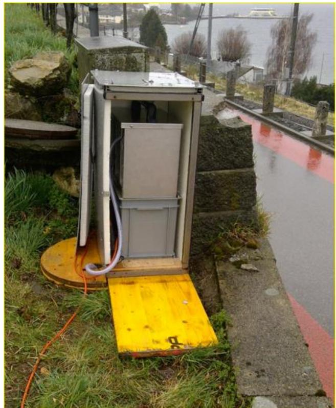
Abbildung 7: Die neun Probenehmer nehmen zeitproportional Abwasserproben, die dann im Labor auf Bromid untersucht werden.
